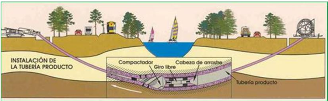
Figura 3.3-4: Instalación de la tubería. Fuente: AECOM, 2024.
